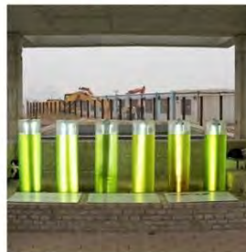
2 初步养殖 光生物反应器养殖法
